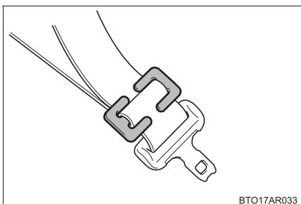
チャイルドシートにシートベルトの固定装置が備わっていない場合は、ロッキングクリップ（別売）を使用してシートベルトにゆるみが生じないようにしっかりと固定する。
