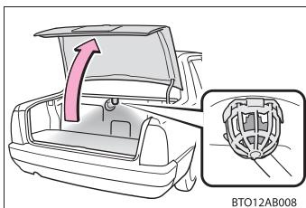
トランクを開けたとき、トランクライトが点灯します。
