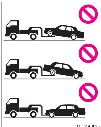
必ず4輪とも持ち上げた状態で運搬してください。タイヤが地面に着いた状態でけん引すると、駆動系部品が破損したり、車の向きがかわり事故につながったりするおそれがあります。
