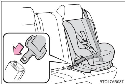
チャイルドシートにシートベルトを取り付け、プレートをバックルに“力チッ”と音がするまで挿し込む。ベルトがねじれていないようにする。
