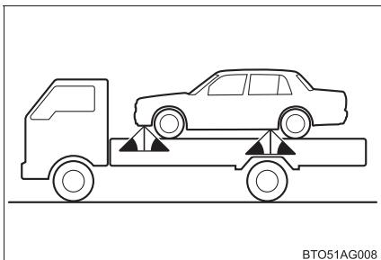
鎖やケーブルなどをして車両を固縛する場合は図に黒く示す角度が45°になるように固縛する
