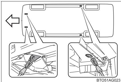
車両運搬車で輸送されているときは、図の場所にフックを取り付ける
