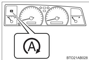
Stop & Start はエンジン スイッチを操作することなくエンジンを停止・始動させるシステムです。Stop & Start によるエンジンの停止中、Stop & Start 表示灯（緑色）が点灯します。（→P. 88）
