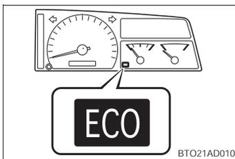
Stop & Start システムはエンジン スイッチを操作することなくエンジンを停止・始動させるシステムです。Stop & Start システムによるエンジンの停止中、アイドルストップ表示灯が点灯します。(→P. 75)
