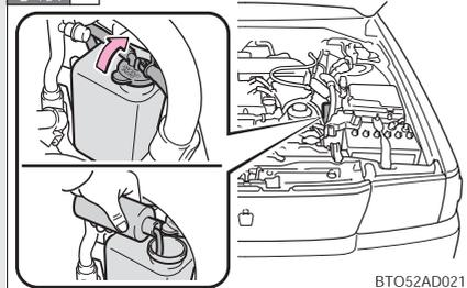
冷却水が不足している場合は、冷却水を補給する（→P. 211）
