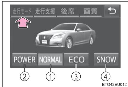
**D ポジションでのレンジ選択(2GR-FSE / 8AR-FTS エンジン搭載車)**
