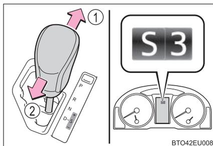
S ポジションへ操作したときのギヤ段は、S4 に設定されます。ただし、D ポジションにて AI-SHIFT 制御中はそれに従い、初期のシフトレンジが S3 または S2 になる場合があります。（→ P. 172）
