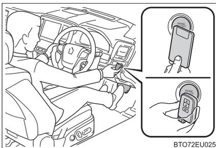
3 ブレーキペダルをしっかりと踏み込んで、マルチインフォメーションディスプレイに
