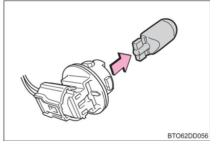
**9** 新しい電球を取り付けてから、ソケットをランプ本体に固定する
