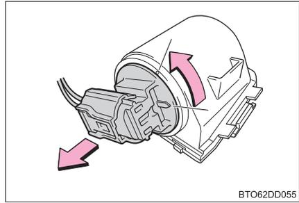
**8** 電球を取りはずす
