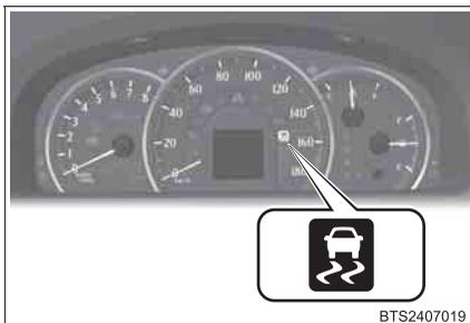
車両が横すべりしそうになったとき、後輪が空転したとき、坂道発進をしたときは、VSC、TRC、ヒルスタートアシストコントロールの作動を表示するためにスリップ表示灯が点滅します。
