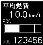
リセットしてからの平均燃費とエコドライブインジケーターゾーン表示を表示します。
