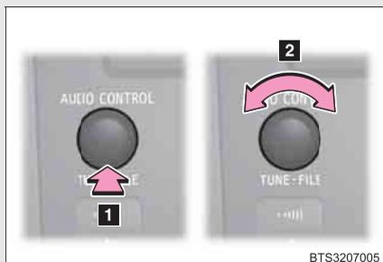
**1** ツマミを押してモードを表示させる
