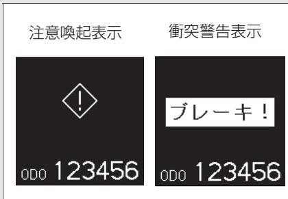
衝突の可能性があると検知したとき、“ピーピーピー”とブザー音が鳴り、PCS 警告灯が点滅し、マルチインフォメーションディスプレイに注意喚起表示が出ます。さらに衝突の可能性が高い場合には、“ピピピ…”とブザー音が鳴り、PCS 警告灯が点滅、衝突警告表示を出し、回避操作をうながします。
