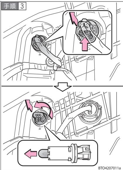
車幅灯を交換するときは、コネクターを取りはずし、電球を取りはずす。
