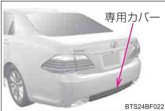
後方プリクラッシュセーフティシステム装着車の専用カバーは、レーダーセンサーの電波透過性に影響します。システムが効果を発揮できるように以下のことをお守りください。
