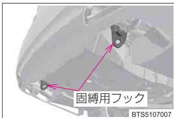
固縛用フックは、船舶固縛で車両を輸送するときを使用するためのものです。他車のけん引には絶対に使用しないでください。けん引に使用すると車両を損傷したり、思わぬ事故につながるおそれがあり危険です。
