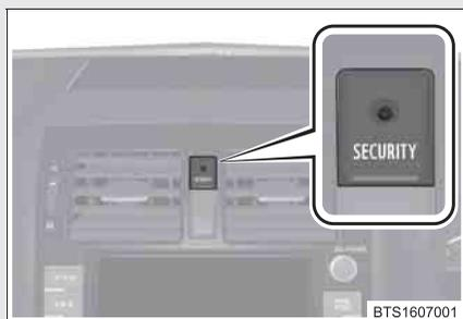
ドア・トランク・ボンネットを閉めスマートエントリー&スタートシステム、ワイヤレスリモコンを使って施錠します。30 秒以上経過すると、自動的に設定されます。
