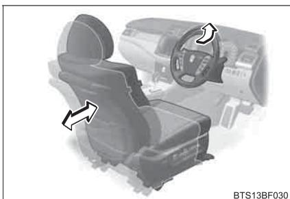
降車時：ハンドルが最上段、最前方に移動、運転席シートが後方に移動（オートアウェイ機能）
