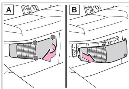
A 吸入口カバーを手前に引いて、図で示す3ヶ所のツメを右端からははずす
