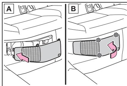
**A** 吸入口カバー左端のツメを差し込む
