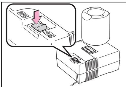
**9** コンプレッサーの電源プラグをアクセサリソケットに挿し込む (→P.270)
