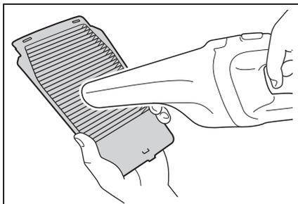
**6** 吸入口カバーにフィルターを取り付ける
