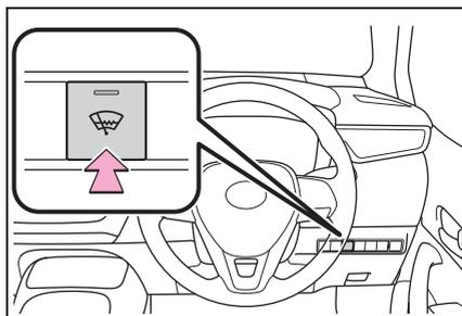
フロントウィンドウガラスとワイパーブレードの凍結を防ぐために使用ください。
