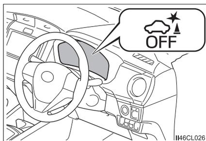
OFF（非作動）に切りかえて、パーキングサポートブレーキ（静止物）を停止させた場合、再度、マルチインフォメーションディスプレイの設定画面からON（作動）に切りかえないとシステムは復帰しません。（パワースイッチの操作では復帰しません）
