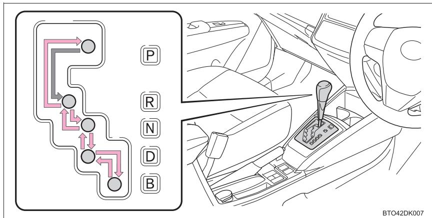
← エンジンスイッチ★が“ON”またはパワースイッチ★がONモードの状態で、ブレーキペダルを踏んだまま操作します。
