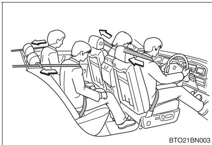
前方から強い衝突を受けたとき、シートベルトを巻き込むことで適切な乗員拘束効果を確保します。
