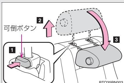
ヘッドレストをいちばん上まで引き上げたあと、可倒ボタンを押して、さらに引き上げ、ヘッドレストを前に倒します。
