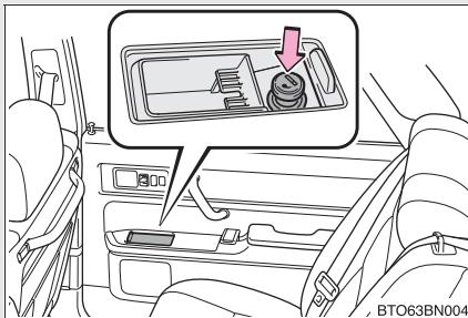
フタを手前に引いて開けて、シガレットライターを押し込む
