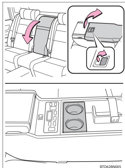
リヤセンタームレストを倒し、レバーを引いてカバーを上げる
