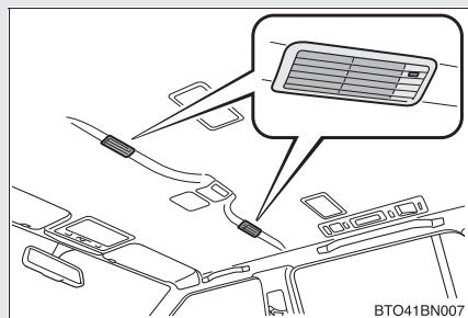
作動している吹き出し口の作動表示灯が点灯します。
