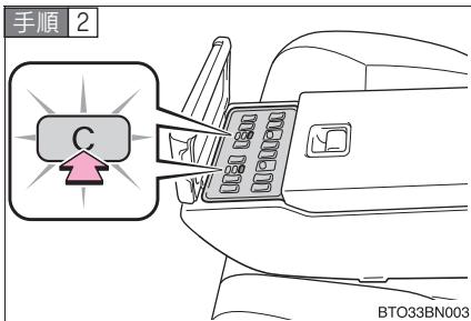
ボタンの C の部分が点灯している状態で、ボタンを押す
