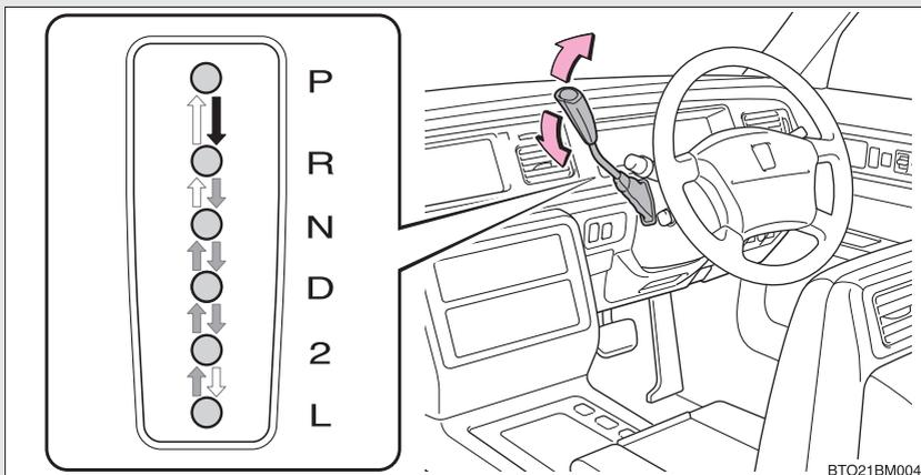
← エンジン スイッチが “ ON ” のときで、ブレーキペダルを踏み、シフトレバーを手前に引いて操作します。
