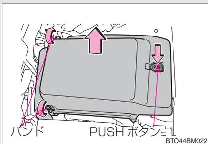
エンジンルームカバーをはずしてから (→P. 238)、バンドを 2 カ所はずし、カバー上の「PUSH」ボタンを押してヒューズボックスカバーをはずす
