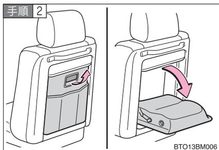
レバーを引き上げ、背もたれの中央部を後方へ倒します。
