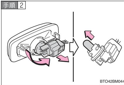
ソケットを取りはずし、ソケットから電球を引き抜く
