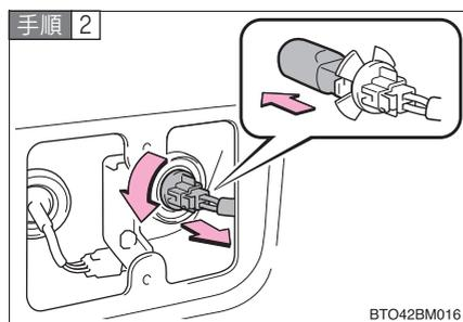
ソケットを取りはずし、ソケットから電球を引き抜く
