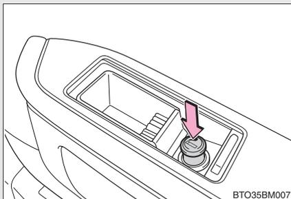
フタをスライドして開けて、シガレットライターを押し込む
