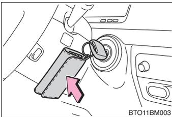
搭載されているキーホルダーをステアリングコラムカバーに近付けると磁石により固定することができます。
