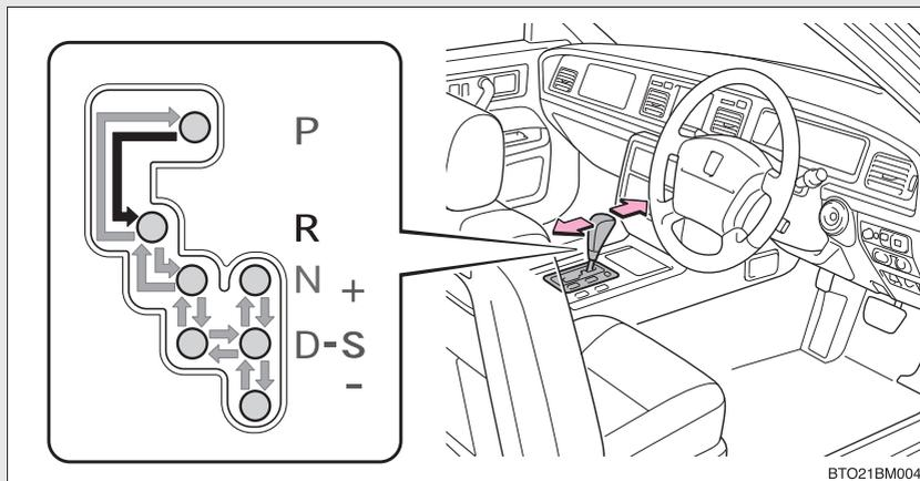
← エンジン スイッチが “ON” の位置で、ブレーキペダルを踏んだまま操作します。
