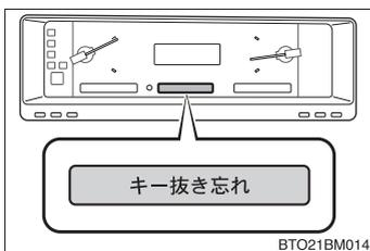
キーが挿してあり、エンジンスイッチが“ACC”または“LOCK”のとき、運転席ドアを開けると警告音が鳴るとともに、マルチインフォメーションディスプレイに警告が表示されます。(→P. 134)
