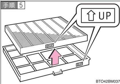
フィルターケースからフィルターを取りはずし、新しいフィルターと交換する
