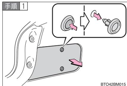
トランクを開け、クリップを取りはずし、カバーを取りはずす
