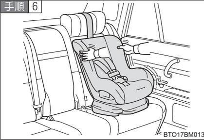
取り付けしたチャイルドシートを軽くゆさぶり、確実に取り付けられていることを確認する
