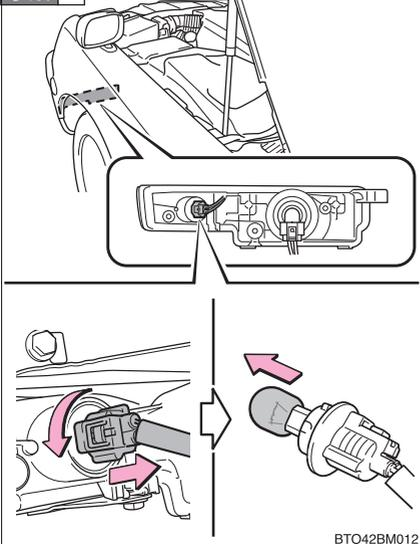
ソケットを取りはずし、ソケットから電球を引き抜く
