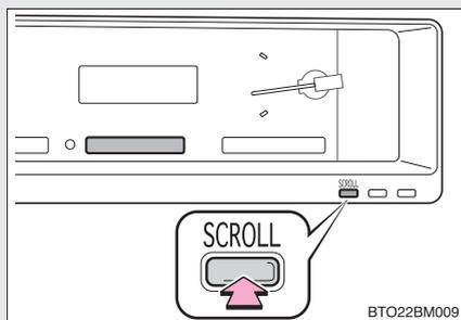
マルチインフォメーションディスプレイにエンジン回転数を表示しているとき、「SCROLL スイッチ」を押す
