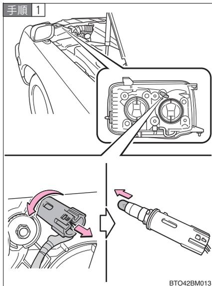
ボンネットを開け、ソケットを取りはずし、ソケットから電球を引き抜く
