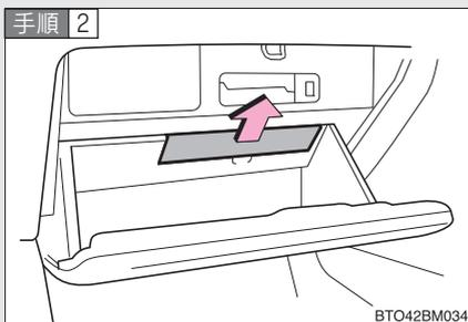
グローブボックスを全開にし (→P. 200)、カバーを上引き抜きます。
