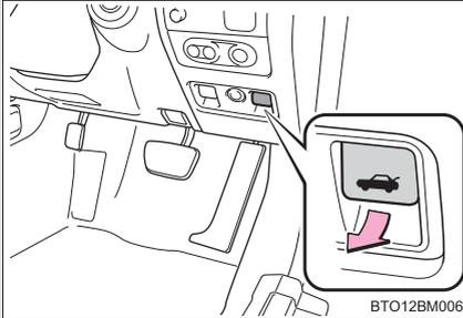
レバーを引き上げて、トランクのロックを解除する。
