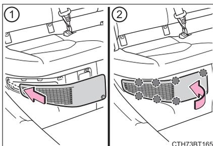
**8** プラスドライバーを使用してクリップを取り付ける
