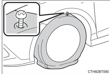
・ パンク補修液がもれないようにするため、パンク箇所が分かっている場合は、パンク箇所が上になるように車両を移動してください。
