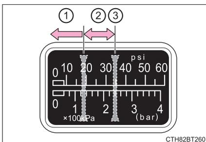
**22** コンプレッサーのスイッチをONにして指定空気圧まで空気を充填し、再度約5 km 走行後にあらためて手順 **20** から実施する
