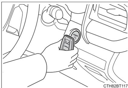
3 ブレーキペダルをしっかりと踏み込んで、マルチインフォメーションディスプレイに
