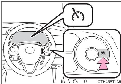
システムが OFF の状態から操作したときのみ、定速制御モードへの切りかえが可能です。
