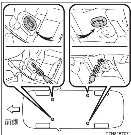
鎖やケーブルなどを使用して車両を固縛する場合は図に黒く示す角度が45°になるように固縛する
