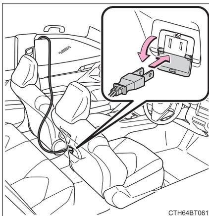
ただし、アース線のある電気製品を使用するときは、トランク内コンセントを使用し、アース線をアース端子に接続してください。
