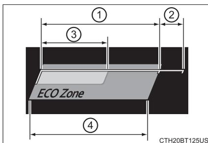
発進・安定走行などの各走行状況に適したアクセル操作範囲の目安が、エコエリア内にゾーン表示されます。
