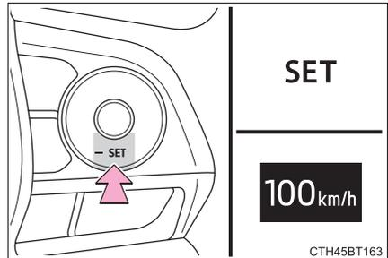
車速が約 50km/h 未満、かつ先行車がいる状態でスイッチを操作したときは、設定速度が約 50km/h にセットされます。
