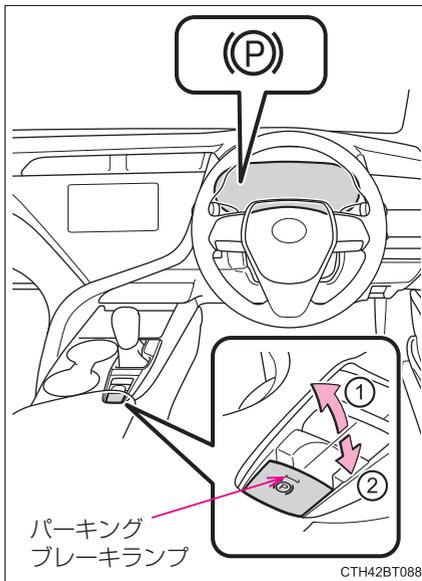
パーキングブレーキ表示灯とパーキングブレーキランプが点滅した場合は、再度スイッチを操作してください。(→ P. 417)
