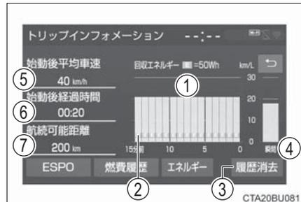
平均燃費はパワースイッチを ON モードにしてからと、前回走行時で色分けして表示されます。
