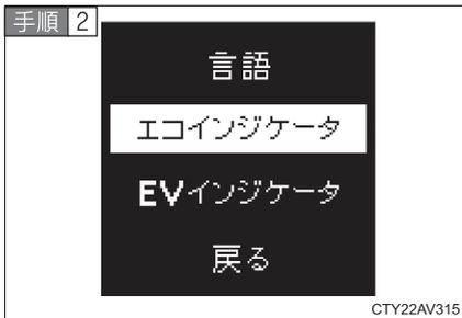
DISP スイッチを押して変更する項目を選択し、DISP スイッチを長押しする
