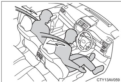
前方・側方から強い衝撃を受けたとき、シートベルトを引き込むことで適切な乗員拘束効果を確保します。
