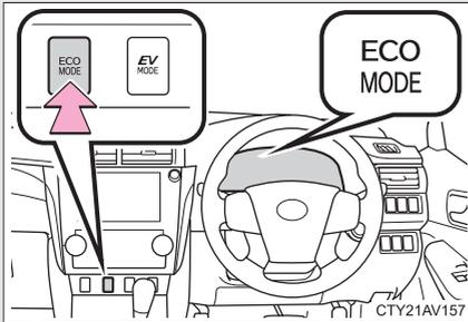
スイッチを押して、エコドライブモードの ON・OFF を切りかえる
