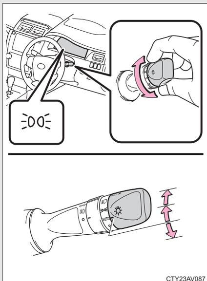
**AUTO** ヘッドライト・車幅灯などを自動点灯・消灯（“パワー”スイッチがONモードのとき）
