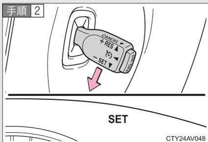
希望の速度まで加速／減速し、レバーを下げて速度設定する
