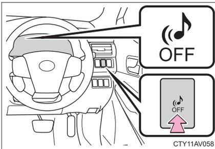
消音するには、“パワー”スイッチが ON モードのとき、スイッチを押す
