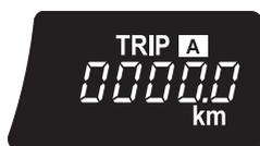
リセットしてからの走行距離を表示します。区間距離は、トリップ A・トリップ B の 2 種類で使い分けることができます。
