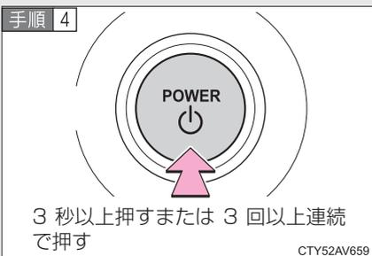
“パワー”スイッチを3秒以上押し続けるか、素早く3回以上連続で押してハイブリッドシステムを停止する。
