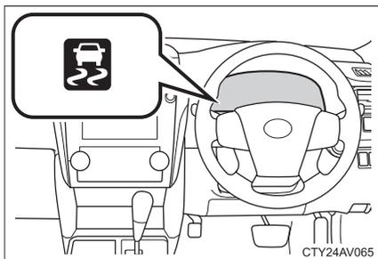
ABS・TRC・VSC が作動しているときはスリップ表示灯が点滅します。
