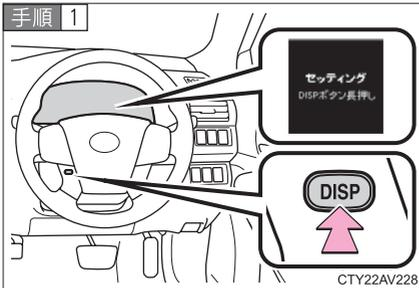
停車中に DISP スイッチを押してセッティング画面を表示させ、DISP スイッチを長押しする
