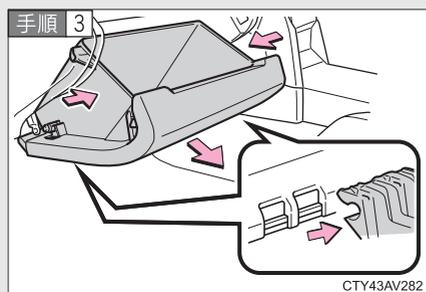
グローブボックス側面を内側に押し、上部のツメを片側ずつはずし、下部のツメをはずして取りはずす
