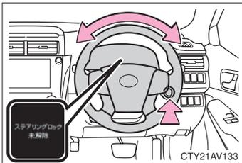
マルチインフォメーションディスプレイに“ステアリングロック未解除”が表示されます。シフトレバーが P の位置にあることを確認して、ハンドルを左右にまわしながら再操作してください。
