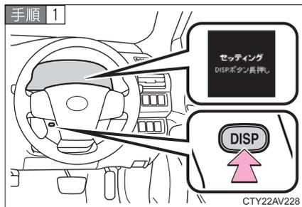
停車中に DISP スイッチを押してセッティング画面を表示させ、DISP スイッチを長押しする
