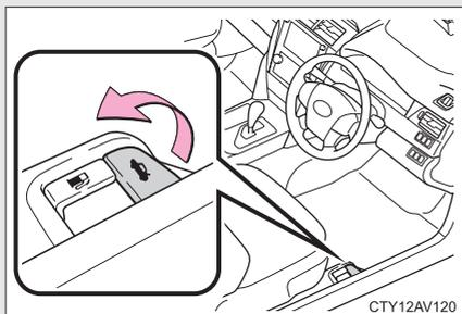
レバーを引き上げて、トランクのロックを解錠する
