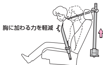
【衝突時規定荷重を維持しながらシートベルトを引き出す】
