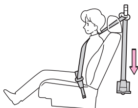
【衝突初期にシートベルトを瞬時に巻き取る】
