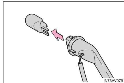
**4** 電球とソケットを取り付けるときは、取りはずしたときと逆の手順で取り付ける
