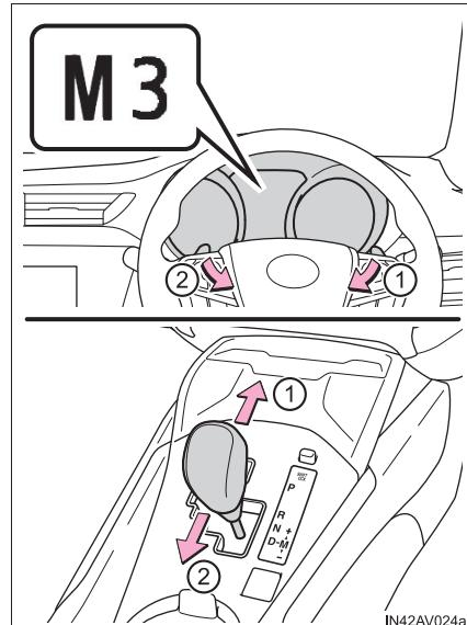
変速段を選択して走行しているときでも、エンジン回転数が上がりすぎそうなとき、または下がりすぎそうなときは、現在の変速段から自動的に1段シフトアップ、またはシフトダウンされます。
