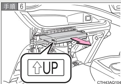
フィルターを取りはずし、新しいフィルターと交換する
