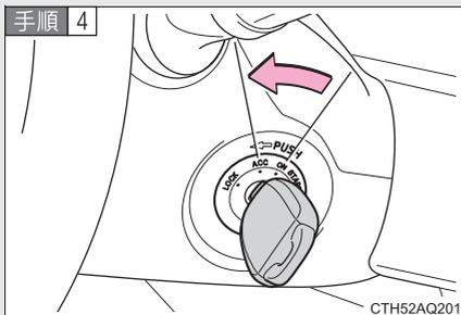
スマートエントリー&スタートシステム非装着車：エンジンスイッチを“ACC”にして、ハイブリッドシステムを停止する
