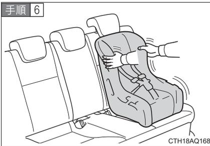
取り付けしたチャイルドシートを前後左右にゆすり、固定されていることを確認する
