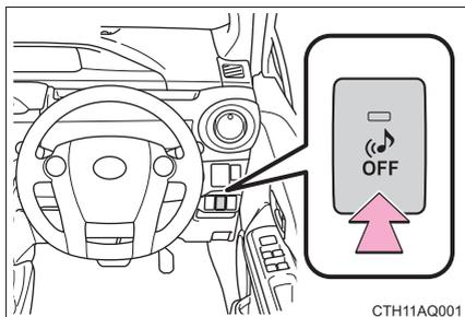
消音するには、エンジンスイッチが“ON”（スマートエントリー&スタートシステム非装着車）または“パワー”スイッチがONモード（スマートエントリー&スタートシステム装着車）のとき、スイッチを押す
