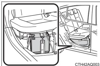
この車両の補機バッテリーはリヤシート下（右側）のカバー内にあり、エンジンルームには搭載されていません。（補機バッテリーはバッテリー液の補充が必要ないタイプのため、バッテリー液量などの点検は不要です）
