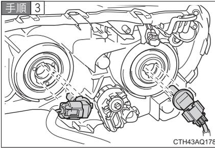
電球を交換し、ソケットを取り付ける
