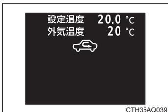
ステアリングスイッチでエアコンの温度調節もしくは外気導入・内気循環の切りかえを行うと、マルチインフォメーションディスプレイに外気温度が表示されます。
