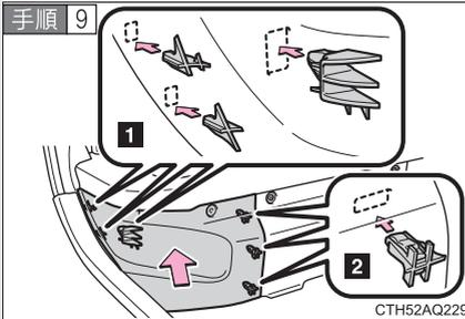
補機バッテリーカバーを取り付ける
