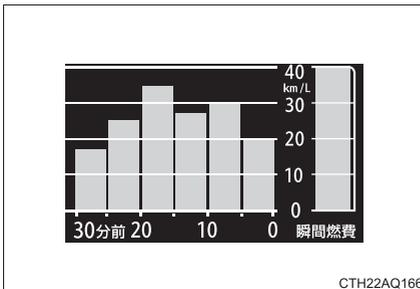
ハイブリッドシステムを始動してからの燃費履歴を 5 分刻みで表示します。瞬間燃費を同時に表示し、30 分前までの燃費と比較することができます。
