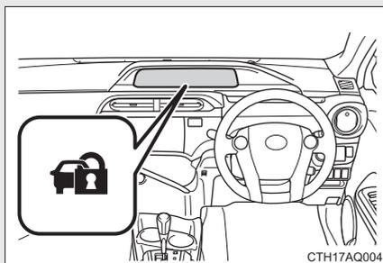
“パワー”スイッチをOFFにすると、システムの作動を知らせるためにインジケーターが点滅します。
