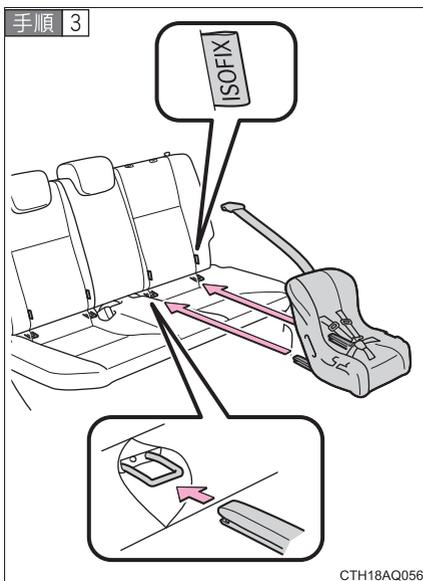
固定専用バーの位置を確認して、チャイルドシートをシートに取り付ける
