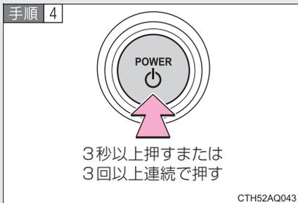
スマートエントリー&スタートシステム装着車：“パワー”スイッチを 3 秒以上押し続けるか、素早く 3 回以上連続で押ししてハイブリッドシステムを停止する
