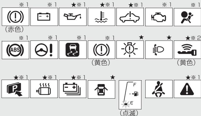
※<sup>1</sup> 作動確認のためにエンジン スイッチを“ON”（スマートエントリー & スタートシステム非装着車）または“パワー”スイッチを ON モード（スマートエントリー & スタートシステム装着車）にすると点灯し、数秒後またはハイブリッドシステムを始動すると消灯します。点灯しない場合や点灯したままのときは、システム異常のおそれがあります。トヨタ販売店で点検を受けてください。
