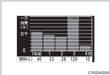
エコウォレットで比較燃費を入力するとお得金額の履歴を表示し、入力しなければ消費金額の履歴を表示します。
