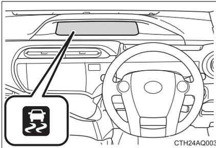
TRC・VSC・ABS・ヒルスタートアシストコントロールが作動しているときは、スリップ表示灯が点滅します。
