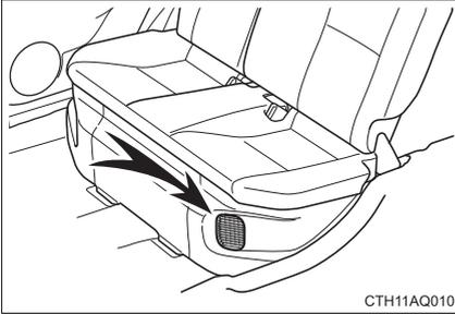
リヤシート下（左側）部には、駆動用電池冷却用の吸入口があります。吸入口をふさいだりすると、駆動用電池の過熱や出力低下の原因になります。
