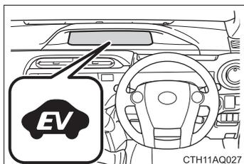
電気モーターの動力のみで走行しているときは、EV 走行インジケータランプが点灯します。
