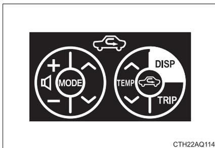
ステアリングスイッチにふれると、表示画面の上にスイッチのイラストが重ねて表示され、手元を見ていなくてもどのスイッチを操作しているか判断できます。
