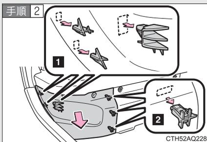
カバー裏のクリップ（3箇所）とガイド（3箇所）のかん合をはずし、補機バッテリーカバーを取りはずす
