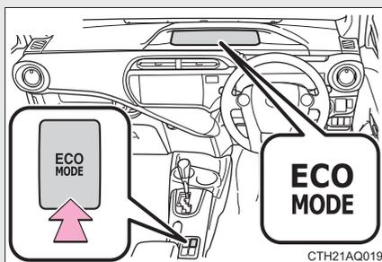
スイッチを押して、エコドライブモードの ON・OFF を切りかえる
