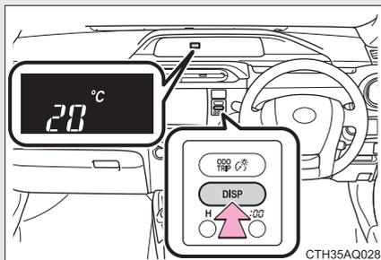
DISP スイッチを押し外気温度表示を表示させます。
