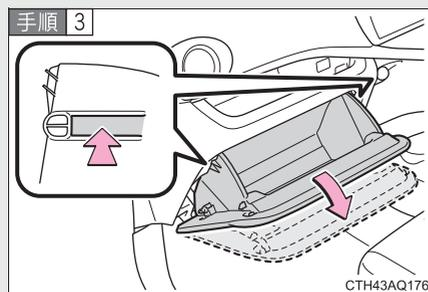
グローブボックス側面を片側ずつ内側に押し、上部のツメをはずす
