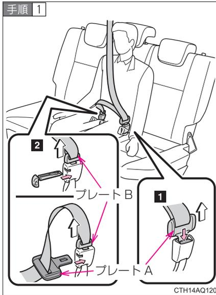
**1** バックルの解除ボタンを押しプレート A をはずす
