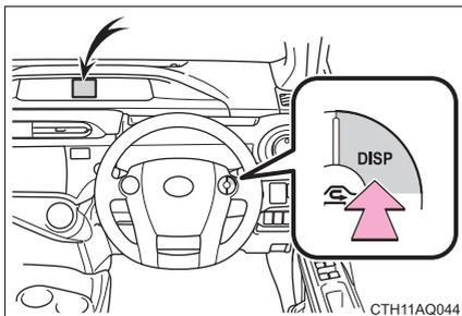
DISP スイッチを押してメニューを切り替え、エネルギーモニターを表示させる
