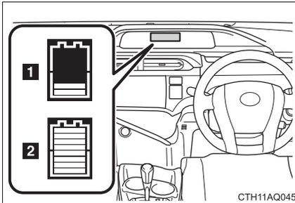
駆動用電池の残量に応じて、表示が 8 段階に変化します。
