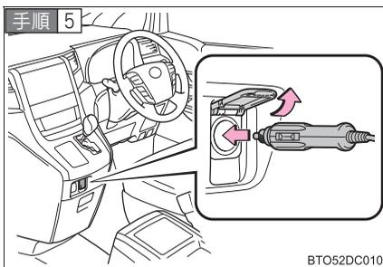
応急修理キットの電源プラグをアクセサリーソケットに挿し込む。
