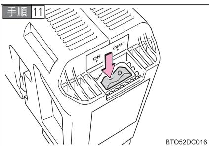
応急修理キットのスイッチを ON にし、パンク補修液と空気を充填する。
