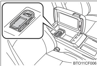
コンソールボックス下部にサービスプラグがあります。サービスプラグはトヨタ販売店で車両の修理時などに、駆動用電池の高電圧を遮断するためのものです。取り扱いを誤ると感電のおそれがあるため、絶対にさわらないでください。
