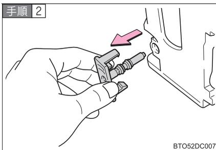
応急修理キットから挿し込みパーツを引き抜く。
