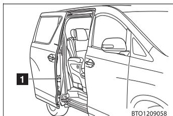
パワースライドドアの前端部には、センサー（**1**）が付いています。ドアを自動で閉めているときに、挟み込みなどによりセンサーが押されると挟み込み防止機構が作動し、その位置からドアは自動的に反対方向に動き、全開位置で停止します。
