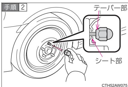
応急用タイヤを取り付け、タイヤがたつかない程度まで手でナットを仮締めする
