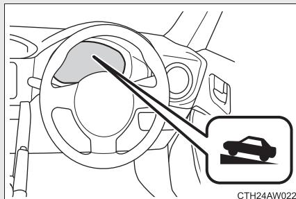
ヒルスタートアシストコントロールを設定するとヒルスタートアシストコントロール作動表示灯が点灯します。ヒルスタートアシストコントロールが作動している場合は、点滅します。
