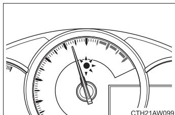
設定したエンジン回転数に到達したことを、表示灯の点灯とブザーの吹鳴でお知らせします。（→P. 186）
