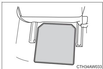
リヤのフロアマットの搭載位置を間違えると、フロントシートをスライドさせた時にフロアマットがシートレールなどに干渉し、車両またはフロアマットを破損するおそれがあります。
