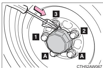
図のように A をナットに取り付けたあと、マイナスドライバーを使用して図の番号順でセンターキャップのツメを押し込む
