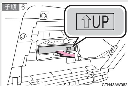
フィルターを取りはずし、新しいフィルターと交換する
