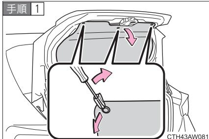
トランクパネルカバー装着車は、クリップを取りはずし、カバーをめくる
