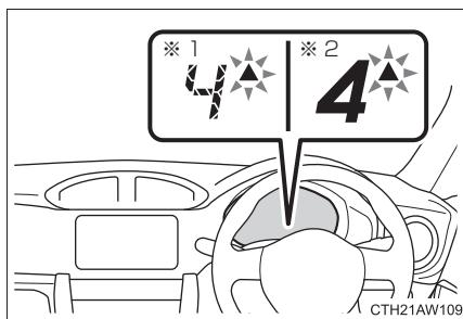
燃費効率の良い運転ができるよう に、シフトアップインジケーター が 3 回点滅し、シフトアップのタ イミングをお知らせします。
