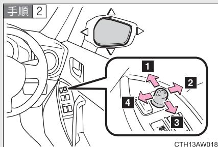
スイッチを操作してミラーを上下左右方向に調整する
