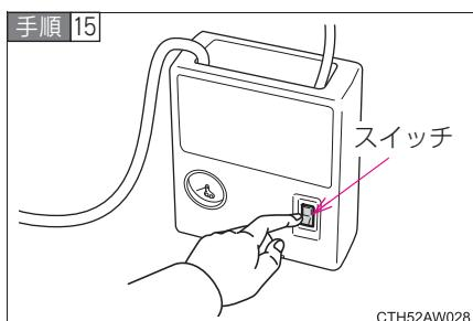
コンプレッサーのスイッチを ONにして、指定空気圧まで空気を充填する
