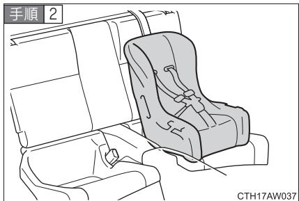
チャイルドシートの取り付け金具をチャイルドシート固定専用バーに取り付けます。
