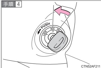
スマートエントリー＆スタートシステム非装着車：エンジンスイッチを“ACC”にして、エンジンを停止する。
