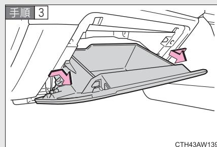
グローブボックス側面を内側に押し、手前へ引いて上部のツメをはずす
