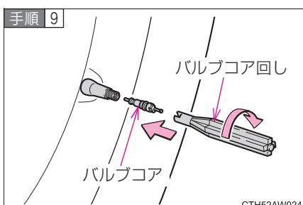
バルブから注入ホースを取りはずし、バルブコア回してバルブコアを時計回りにまわしてバルブにしっかりとねじ込む
