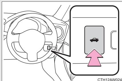
トランクオープナースイッチを長押しして、トランクのロックを解除する
