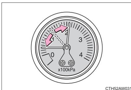
空気圧が 130 kPa 以上の場合は、指定空気圧まで空気を充填する
