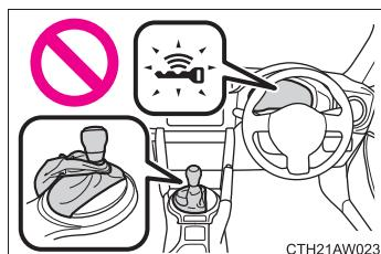
オートマチック車：シフトレバーが P の位置にあるか確認してください。エンジンを始動するときに、シフトレバーが傾いたり、P 以外の位置にするとステアリングロック機能が作動しエンジンを始動することができないことがあります。スマートエントリー & スタートシステム表示灯が緑色に速く点滅します。
