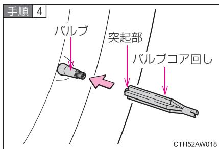
バルブコア回しの突起部をバルブに押しあて、空気を抜く
