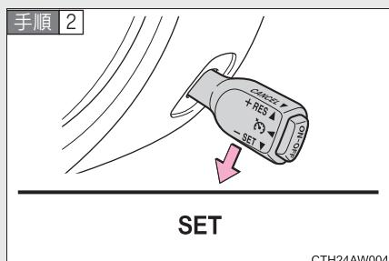
希望の速度まで加速／減速し、レバーを下げる設定する
