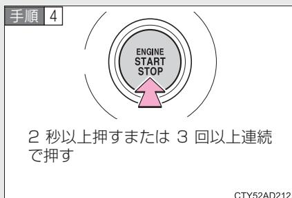
スマートエントリー＆スタートシステム装着車：“エンジン スタート ストップ”スイッチを 2 秒以上押し続けるか、素早く 3 回以上連続で押してエンジンを停止する。
