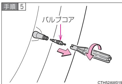
バルブコア回しでバルブコアを反時計回りにまわして抜き取る
