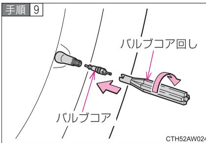
バルブから注入ホースを取りはずし、バルブコア回しでバルブコアを時計回りにまわしてバルブにしっかりとねじ込む
