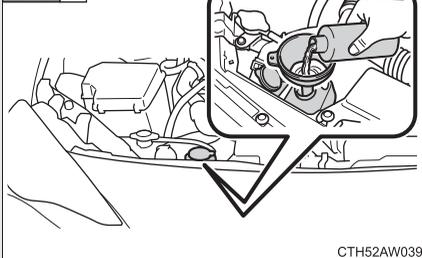
冷却水が不足している場合は、冷却水を補給する
