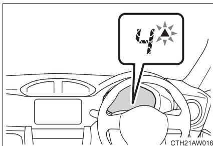
燃費効率の良い運転ができるように、シフトアップインジケーターが3回点滅し、シフトアップのタイミングをお知らせします。
