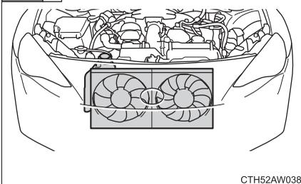
エンジンが十分に冷えてから、冷却水の量やラジエーターコア部（放熱部）の冷却水漏れを点検する
