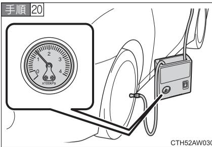
圧力計で空気圧を確認する
