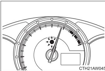
設定したエンジン回転数に到達したことを、表示灯の点灯とブザーの吹鳴でお知らせします。(→P. 164)
